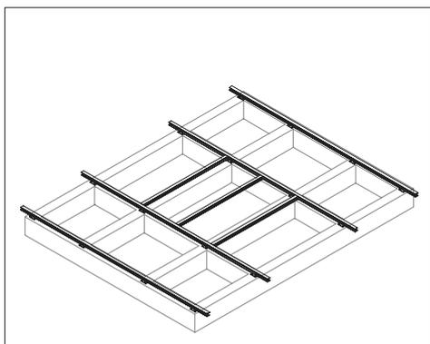
Statisch berechnete, feuerverzinkte Stahlkonstruktion mit vorgerichteten Bohrungen zur Aufnahme der Familienhaus-Bodenplatte. Alle Stahlträger mit Schraubplatten, vorgerichtet zur Verbindung mit dem Fundamenten.
