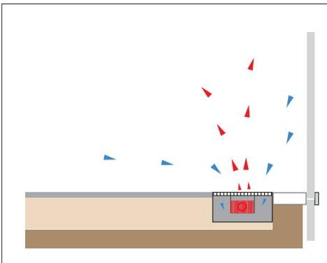
Bodenkanalheizung mit Gitterschachtab-
