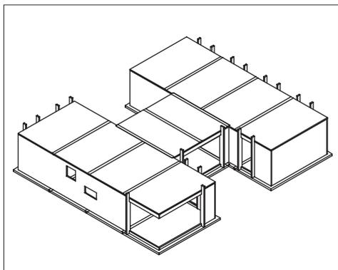
Statisch berechnete Massivholz-Plattenkonstruktion, Wand Lenokerto 85mm, Boden Leno 135mm + Schutzanstrich, Decke Leno135mm, Dach Leno 85mm, Aufteilung siehe Bauplan!
