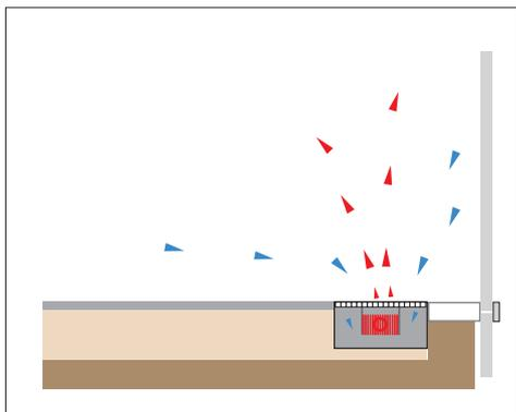
Fußbodenunterflurheizkonverter mit Gitterschachtabdeckung, Steuerung des Wärmebedarfs über die **KRAUSS**-Objektsteuerung. Für den Eingangsbereich, Küche und Bad Fertig-Heizkörper Farbe weiß je nach Bedarf.
