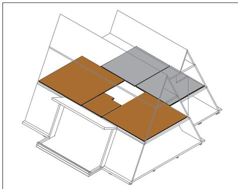
Fußbodensystem auf Schallschutz - Bodenkonstruktion, 25 dB, für integrierte Verlegung der Versorgungsleitungen wie Elektro, Wasser, Abwasser, Heizung, EDV oder sonstige Medien.
