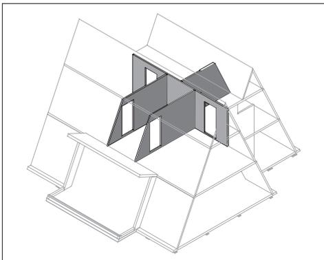
Massivholz Zwischen-Wandsystem 81mm stark nach dem Grundriss des Waldhauses. Oberfläche vorgerichtet für MDF Beplankung.
