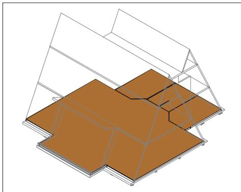
Fußbodensystem auf PU- Bodenkonstruktion, Wert 0,14W/m²K, für integrierte Verlegung der Versorgungsleitungen wie Elektro, Wasser, Abwasser, Heizung, EDV oder sonstige Medien.
