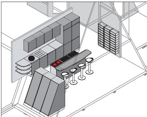
Einbauküche Fabr. IKEA, mit allen Elektrogeräten, Dunstabzug, Spülbecken mit Kalt- u. Warmwasserbatterie. Kücheneinrichtung siehe Küchenplan.
