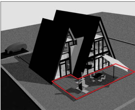
**KRAUSS TERRASSEDECK** siehe Bauplan, Ausführung in Stahl feuerverzinkt mit Alurandprofil und Douglasie-Rollrost wie im Internet unter [www.krauss-innovation.com](http://www.krauss-innovation.com) beschrieben.
