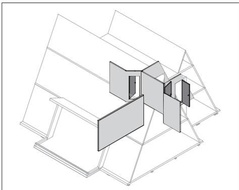
Zimmertüren bzw. Schiebetüren in Holz- oder Metallzargen, Holz natur, Holz lack. oder ESG-Türblätter im Gletscher Design mit A2 Beschlägen.
