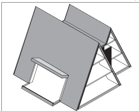
Metallfassade aus 1mm starkem Aluminium-Wellprofil 76x18mm oder mit Kassetten in verschiedenen Maßen (siehe Liste) nach Farbkarte einbrennlackiert. Mit Edelstahlschrauben gehalten bzw. verschraubt.
