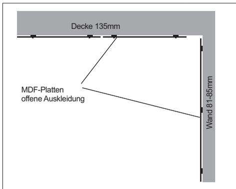
MDF Mittelfeine Möbelbauplatte 10mm an der Zwischenwandkonstruktion mit 38mm Abstand eingehängt. Oberfläche gestrichen, Farbwahl nach Karte. Vorzüglich geeignet für versteckte Verkabelungen oder besondere Applikationen.
