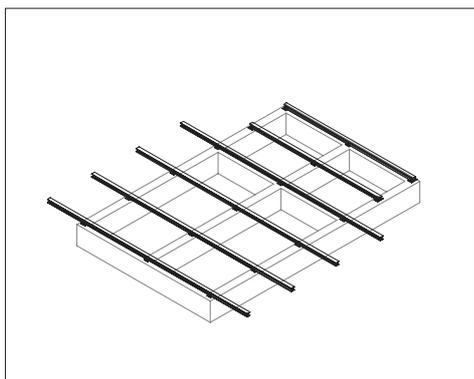
Statisch berechnete, feuerverzinkte Stahlkonstruktion mit vorgerichteten Bohrungen zur Aufnahme der Waldhaus-Bodenplatte. Alle Stahlträger mit Schraubplatten, vorgerichtet zur Verbindung mit dem Fundamenten.
