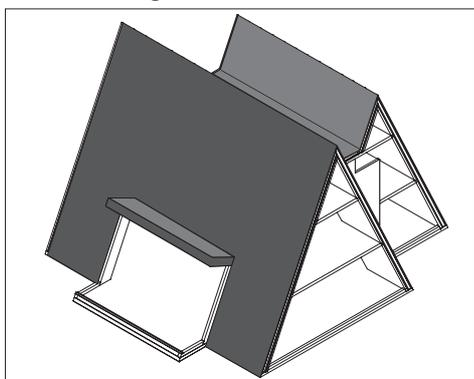
Bitumenschindel-Dachhaut auf OSB-Platten vermagelt. Flachdach zwischen den Spitzgiebel mit Keillatten für Entwässerungs-Dachgefälle. Gefälleflachdach-Oberfläche aus Dachfolie verschweist. Ug - Wert des Flachdachaufbaues 0,14 W/m²k.
